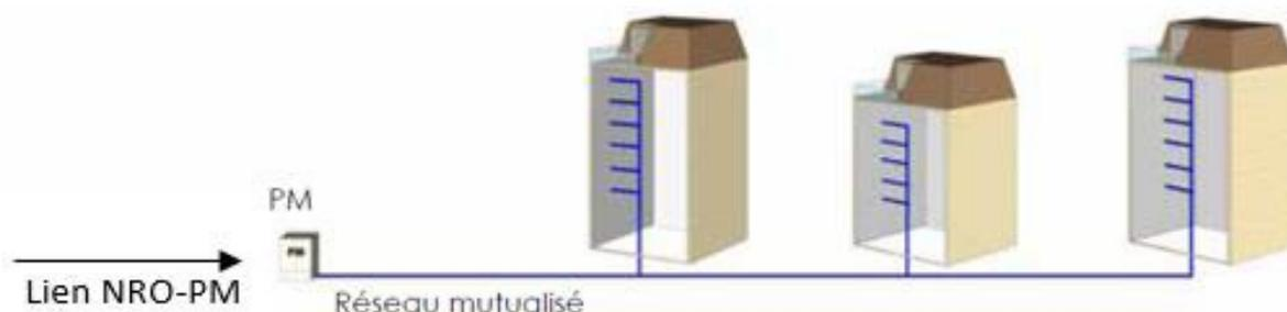
Pour la construction de nouveaux immeubles collectifs, Val de Loire Fibre installe les lignes de fibre optique depuis son Point de Mutualisation jusqu'aux PR des différents bâtiments prévus par le maître d'ouvrage.
